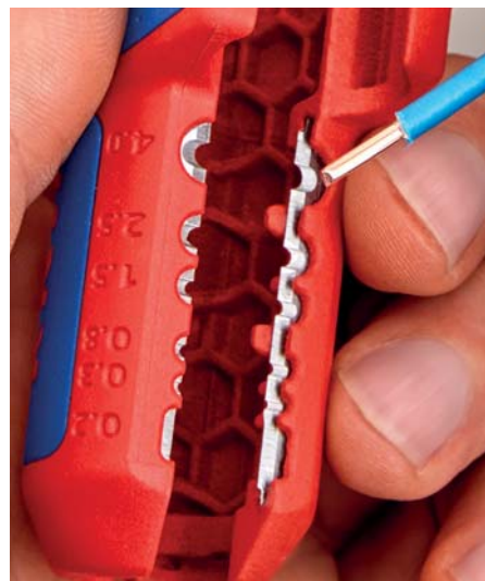
Odizolování jednotlivých vodičů
