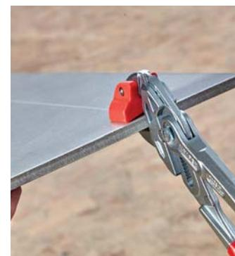
Plastová dosedací čelist: otočná pro čistý lom a optimální ochranu dlaždice před poškozením
