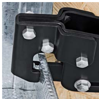
Nasazení kleští na dva spojované profilované plechy
